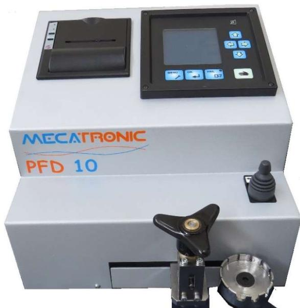
Dinamometro per la misurazione della forza di sfilamento del terminale (trazione, compressione, mantenimento, rottura).
