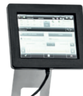
Pannello touch-screen da 5.7 pollici con software intuitivo e librerie di programmazione
