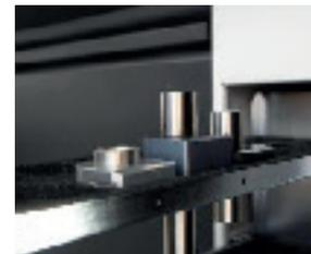
Guide con codice colore per operazioni semplificate e riduzione dei tempi di setup
